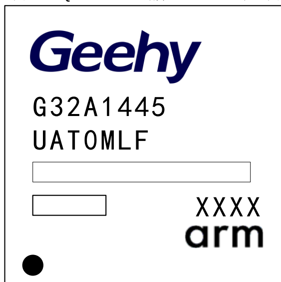
图 32 LQFP48 – 48 引脚，7 x 7mm 示意图
