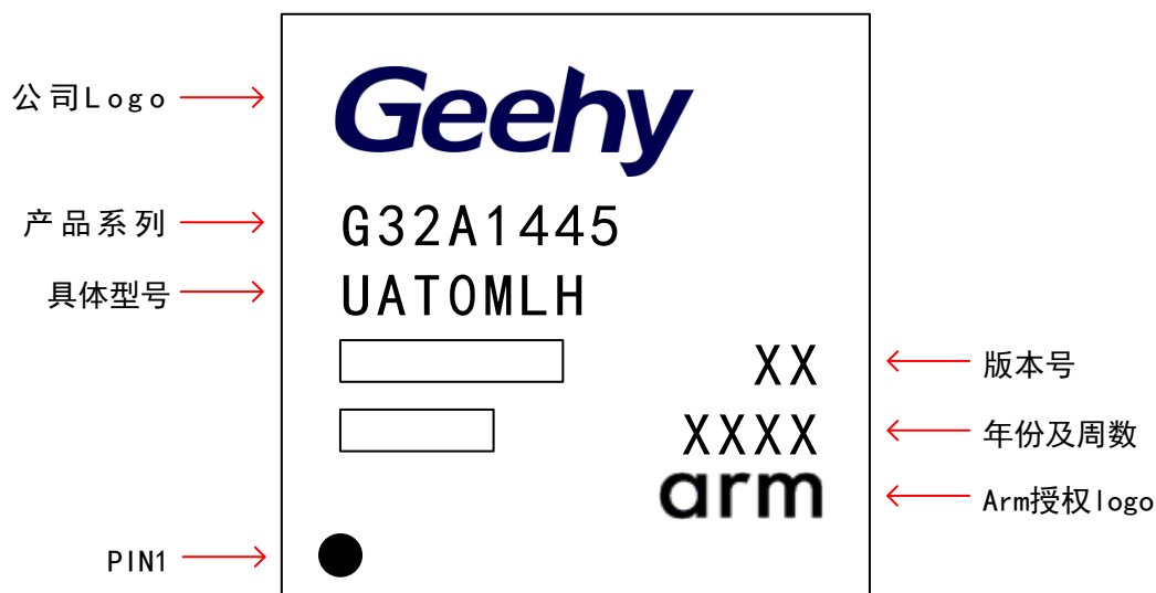
图 29 LQFP64 – 64 引脚，10 x 10mm 示意图
