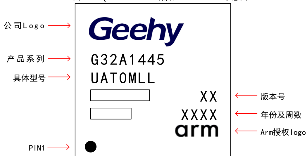
图 26 LQFP100 – 100 引脚，14 x 14mm 示意图
